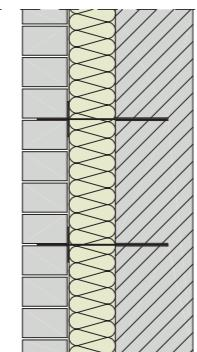
Das zweischalige Mauerwerk mit Dämmung wird nach DIN EN 1996 (Eurocode 6)/DIN 1053-1 geregelt und gehört zu den anerkannten Regeln der Technik. Der lichte Abstand der beiden Schalen beträgt in der Regel maximal 150 mm, kann bei der Verwendung speziell zugelassener Mauerwerksanker aber auf 250 mm erweitert werden.
